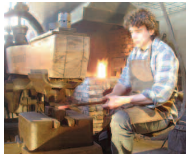
Forge. Façonnage d'outils au martinet.
